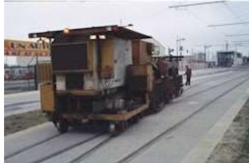
2) Une meuleuse venue d'Italie intervient sur les voies de service qui précèdent l'entrée du dépôt "La jeune Parque".
