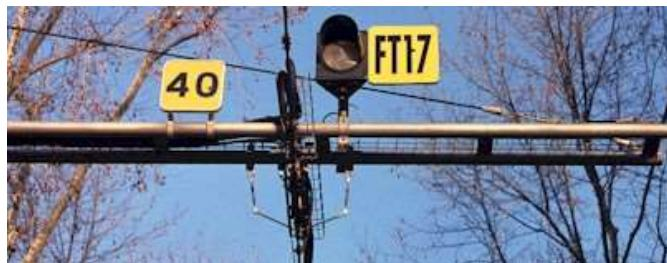
Ci-dessus, un exemple de signalisation de vitesse maximum et de secteur de la ligne aérienne de contact (L.A.C.). Le feu permanent orange signifie que le secteur de ligne est sous tension. Un feu clignotant orange indique que l'alimentation en courant électrique est interrompue sur le secteur concerné. La mention FT signifie "Feu de présence Tension".
